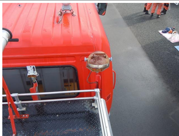
車体上部の錆
