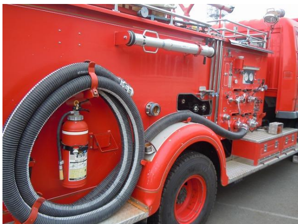
吸水管、高発泡ノズル、消火器
