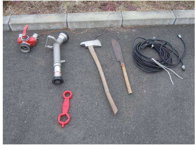
無反動ノズル、消火栓ハンドル、二又分水器 斧、鋸、オイルパンヒーター線
