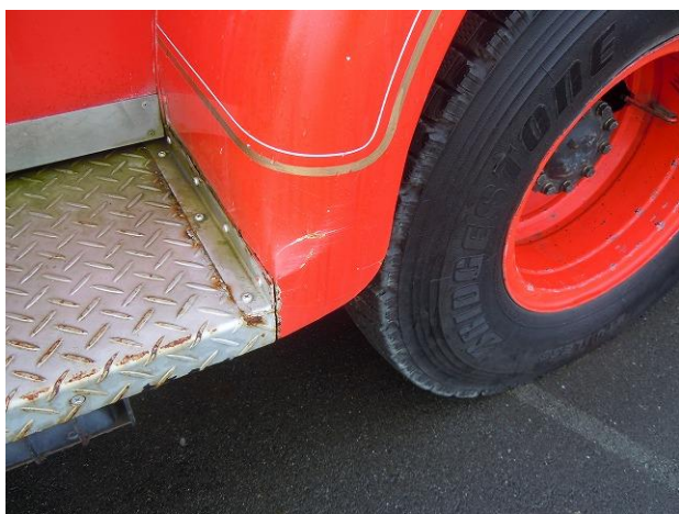
助手席側後輪付近に傷 ステップ部分の錆
