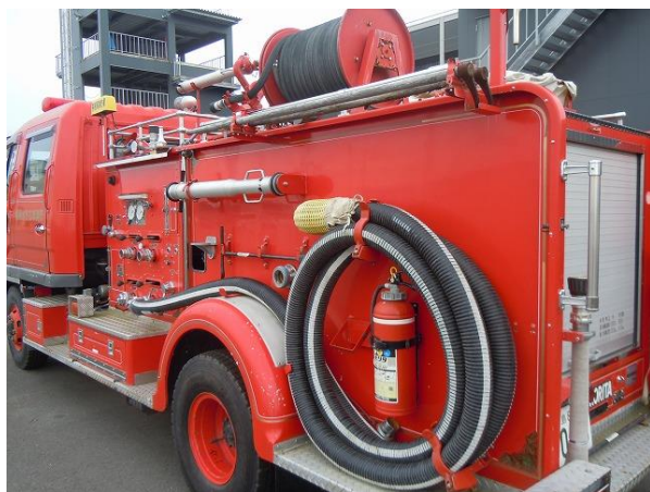
吸水管、高発泡ノズル、消火器、とび口2本 スピンドルドライバー
